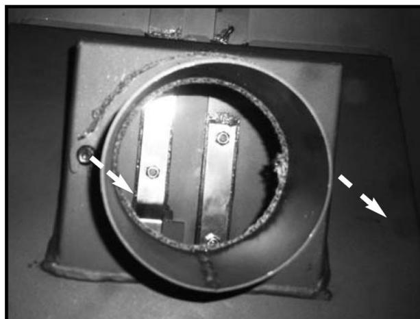
Désserrer les 2 vis de fixation de la buse d'air (clé Allen de 3)
