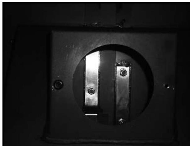
Démonter la buse d'entrée d'air du boîtier.
