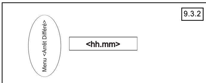
Sélectionner, renseigner et valider l'heure du menu <Arrêt Différé> avec l'heure d'arrêt du poêle.
